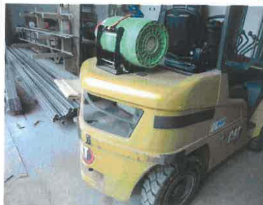
Zadní pohled na VZV a plynovou láhev s držákem
