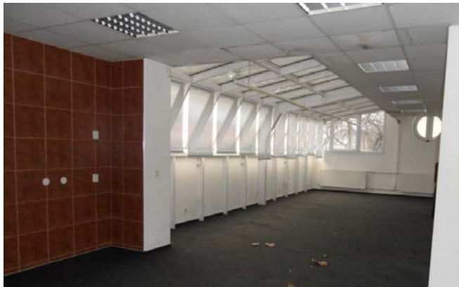
Lehké dělicí průčky lze v podlažích variabilně přemísťovat zasedací místnost, část stropů tvoří střešní okna
